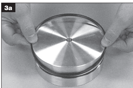
3a ポリウレタン製のピストンリングは簡単に伸ばすことができます。
