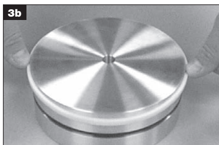
3b 改良型PTFE製のピストンリングは伸長を最小限に抑えて機器の溝に設置します。改良型PTFE素材は溝の中に均一に押しこむ必要があります。ばらつきのある伸長や過剰な伸長は避けてください。
